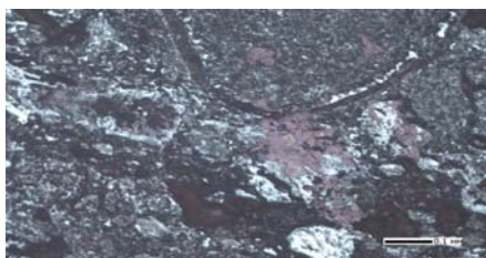
Рис. 11. Проба ТП-3. Манганокальцит с вернадитом (?) в пиролюзите. Аншлиф, отраженный свет, увел. 150
