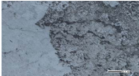
Рис. 7. Проба ТП-1. Пиролюзит с псиломеланом и жаншуитом (?). Аншлиф, отраженный свет, увел. 100
