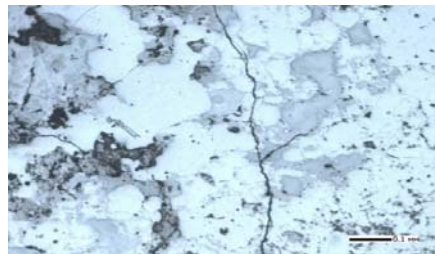
Рис. 10. Проба ТП-3. Пиролюзит-псиломелановая руда. Аншлиф, отраженный свет, увел. 150
