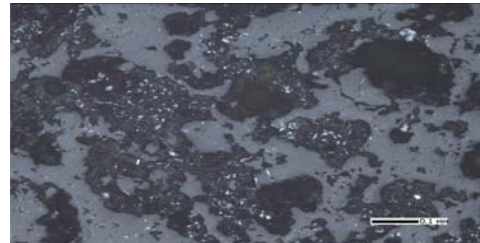
Рис. 8. Проба ТП-1. Кремнистая порода с гематитом (иглолочки и тонкая вкрапленность) и гидроксидами железа. Аншлиф, отраженный свет, увел. 100
