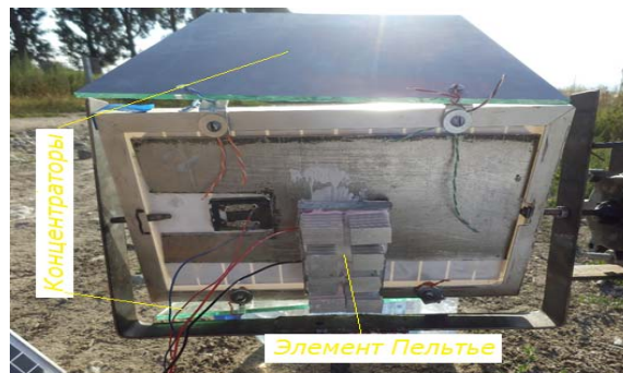
4-сурет. Пельтье элементі негізіндегі суыту жүйесі
